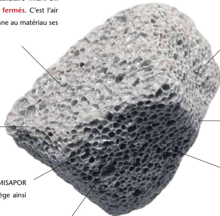
**ANTICAPILLARITÉ** | Grâce à sa faible teneur en particules fines, MISAPOR forme une **barrière anticapillarité** qui préserve les bâtiments de l'humidité. Résultat: aucune formation de moisissures ni dégradation de la construction.
