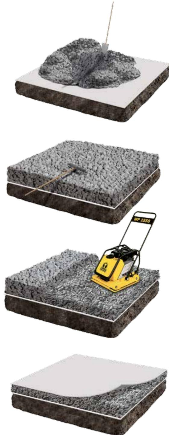
MISAPOR peut être épandu directement sur un terrain grossièrement aplani, soit à l'aide d'une chargeuse sur roues/excavatrice, ou encore d'une grue et de baches de déversement ou de big-bags. Le remblai doit être soutenu latéralement (terre existante, gravier, ballast, planches de coffrage). Comme couche de protection, on place sous l'agrégat de verre cellulaire un géotextile qui doit être rabattu sur les bords.
