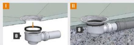
**I** Gummidichtung auf das Ablaufgehäuse legen und Sitz überprüfen. Ablaufstutzen an weiterführende Abwasserrohre anschließen. Einlauföffnung mit Schneidhilfe verschließen.
