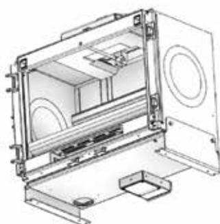
Boîte à air en option permettant de déporter le raccordement d'arrivée d'air à travers la cloison arrière
