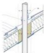
Distance de sécurité autour d'un conduit de fumées
