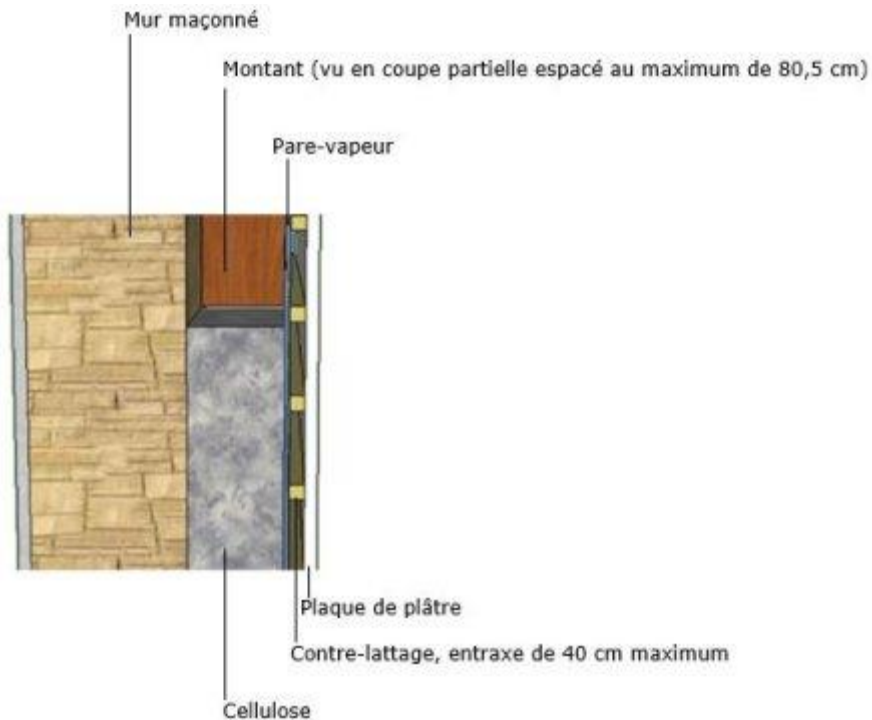
Figure 3 - Mur maçonné - Isolation intérieure
